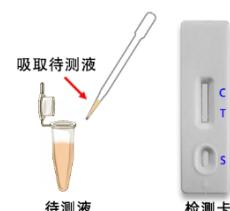
(3) 垂直滴加到检测卡的加样孔中；液体流动时开始计时，8~10 分钟进行结果判定，其他时间判定无效。
