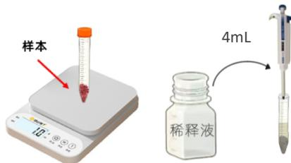
(3) 涡旋振荡 1 分钟，室温下 4000 转/分钟离心 2 分钟，上层清液作为样本液；取稀释液 450 $\mu$ L，再加入 50 $\mu$ L 样本液，作为待测液。
