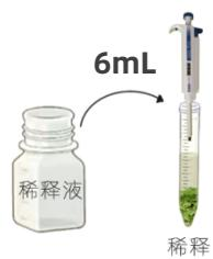
(3) 涡旋仪涡动或手动上下振摇1分钟，静置1分钟，得样品液；按下表将样品液与稀释液按不同比例稀释，稀释后的溶液为待测液。
