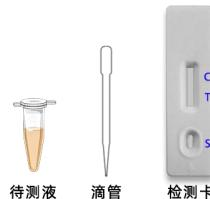
(2) 用移液器或滴管吸取 100  $\mu$ L (约 3 滴) 待测液。
