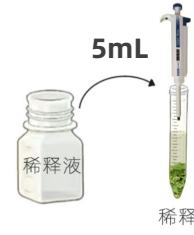
(3) 涡旋仪涡动或手动上下振摇1分钟，静置1分钟，得样品液；按以下表将样品液与稀释液按不同比例稀释，稀释后的溶液为待测液。
